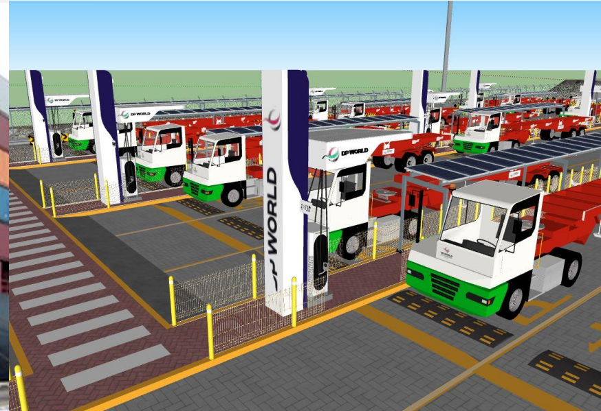
CENTROS DE CARGA DE ELECTRICIDAD PARA CAMIONES ELECTRICOS. INCLUYE PANELES SOLARES.
