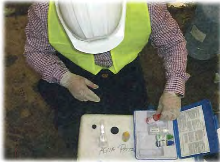
Foto N° 13 – Adicionando reactivos para preservar la muestra
