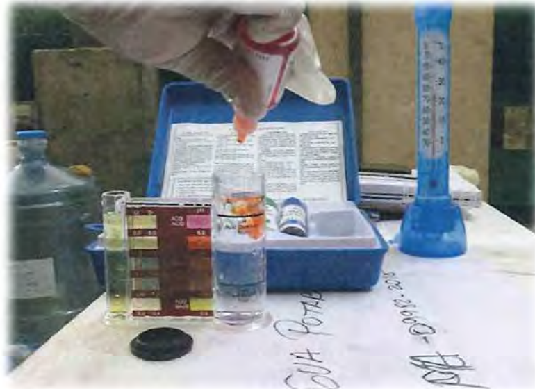
Foto N° 15 – Adicionando reactivos para preservar la muestra
