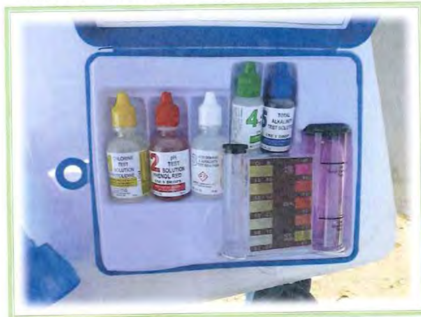
Foto N° 22 – Reactivos para medición de ph y cloro residual
