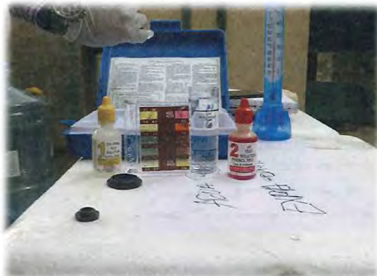
Foto N° 14 – Reactivos para medición de ph y cloro residual
