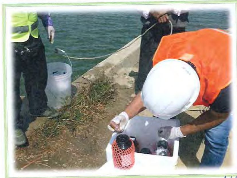
Foto N° 14 – Adicionando reactivos para preservar la muestra
